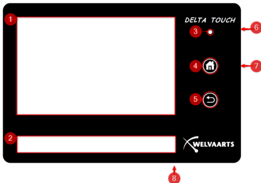
Figuur 1.2: de Delta-Touch met genummerde kenmerken
